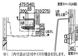
注1: 躯体柱内面~UB.WLまでの寸法は、戸建木軸工法時の参考寸法を示します。本寸法は現場状況により異なります。
