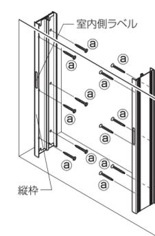
※縦枠の向きは縦枠に張ってあるラベルを参照してください。
