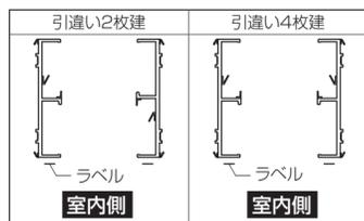
※縦枠の位置出しは下図のように窓枠室内側から一定にしてください。
