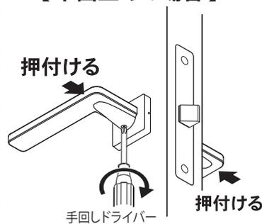
**必ずハンドルを押し付けて固定してください。ハンドルと座の間に隙間が生じ、ハンドルのカタツキの原因となります。**
