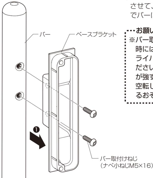
②ベースブラケットを反転させて、裏面より①のねじでバーに固定します。
