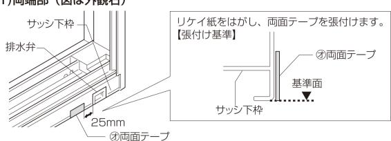
※シャッター・雨戸サッシの場合、両面テープ張付け位置は下枠端部から 100mm になります。
