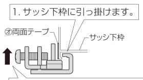
2. 下枠ブラケットを矢印方向に 押付け、位置を決めます。
