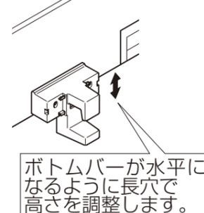
ボトムバーが水平になるように長穴で高さを調整します。
