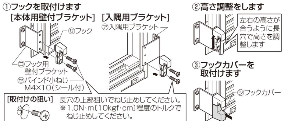
左右の高さが合うように長穴で高さを調整します
